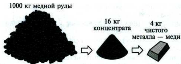
Рис. 8.5. Выход меди из 1 т руды в металлургическом производстве
