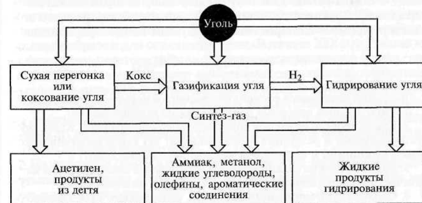
Рис. 14.1. Схема переработки каменного угля
