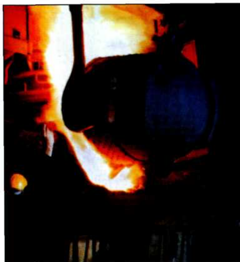
Рис. 36. Заполнение кислородного конвертера расплавленным чугуном
