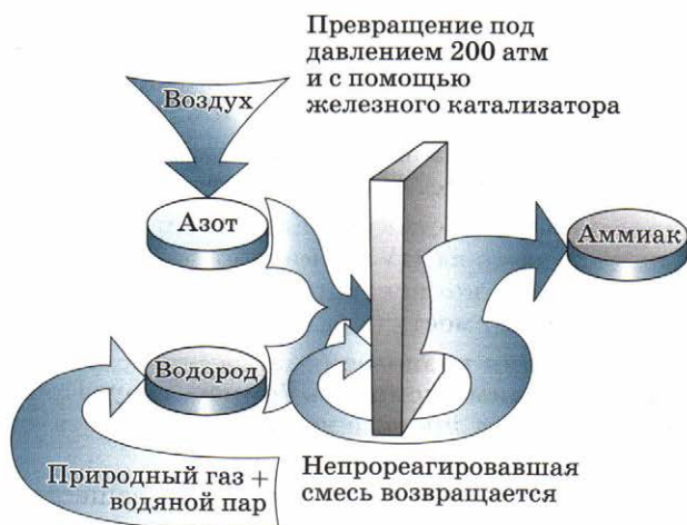
Рис. 107. Схема промышленного получения аммиака
