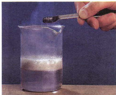
Рис. 95. Разложение пероксида водорода при внесении катализатора — оксида марганца (IV)
