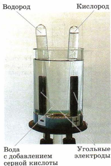
Рис. 114. Электролиз воды в лабораторных условиях
