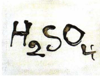
Рис. 129. Обугливание бумаги концентрированной серной кислотой
