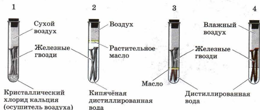
Рис. 121. Коррозия железа в различных условиях
