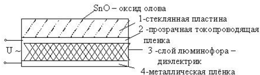
Рис. 6.2. Структура электролюминесцентного индикатора:
