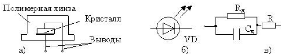
Рис. 5.2. Конструкция (а), УГО (б) и эквивалентная схема (в) светодиода
