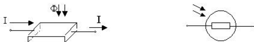
Рис. 5.3. Конструктивное представление и УГО фоторезистора
